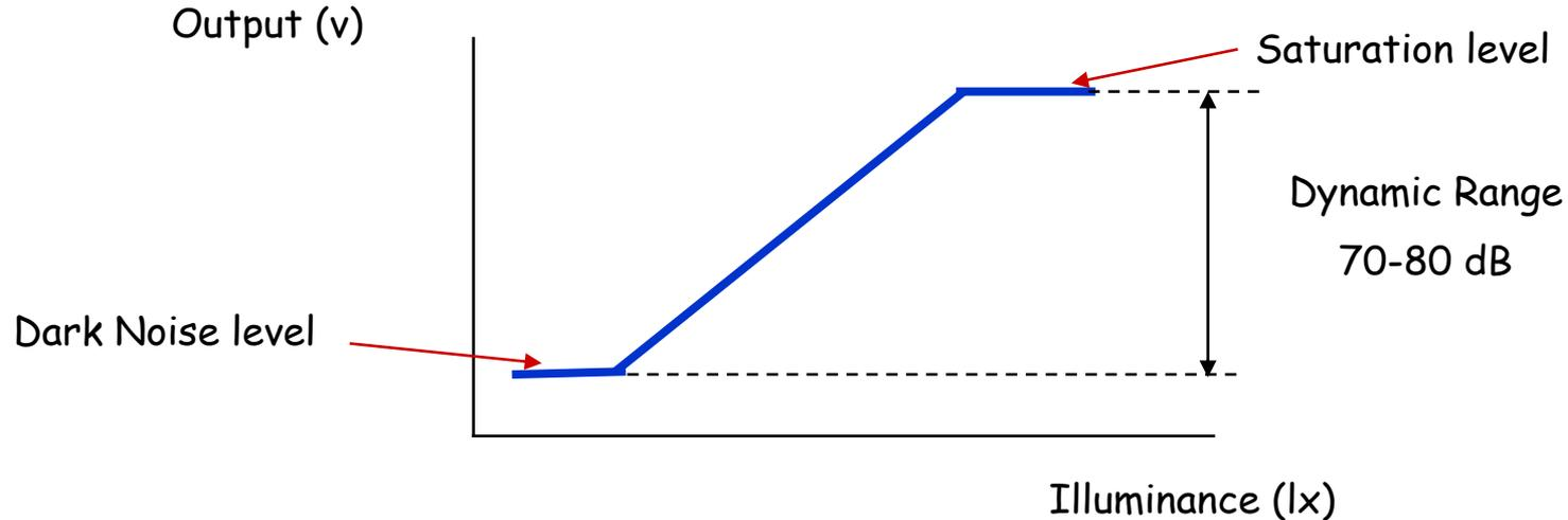
□ Dynamic range  $20 * \log_{10} ( V_{\max} / V_{\min} )$
